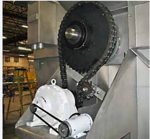
Motor, engranajes y cadena de la transmisión diseñados para servicio pesado: mayor vida útil
